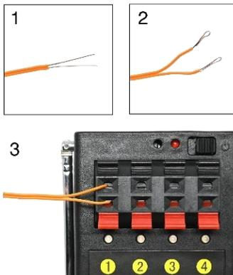
Nachdem Sie einen oder mehrere Zünder eingesetzt und das Gerät eingeschaltet haben, sollte jeder Kanal mit angeschlossenem Zünder grün leuchten. Dies wird als **Durchgangstest** bezeichnet und das Gerät bestätigt, dass stromführende Anschlüsse angeschlossen sind. Leuchtet die LED nicht grün, ist der Zünder entweder nicht angeschlossen, wurde bereits gezündet oder ist defekt.
